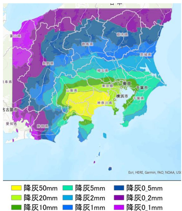
図4-1 悲観的シナリオの各降灰深地域について、ArcGISProを用いてポリゴンデータ化を行った状態
